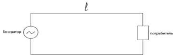
Рис.99. Модель линии передачи
